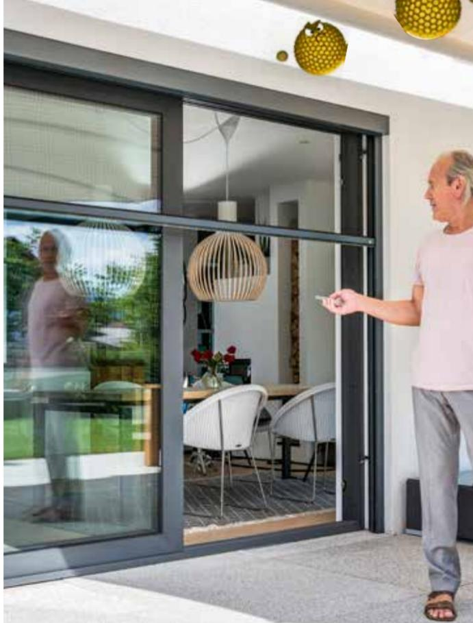
Elektro-Rollos – Die geräuscharmen Anlagen sind speziell für den Einsatz an großen Glasflächen ohne Türschwenkbereich konzipiert. Die Handhabung per Wandbedienung oder Funkhandsender ist bequem und einfach. Bei Nichtnutzung verschwindet das Elektro-Rollo in der Kassette.
